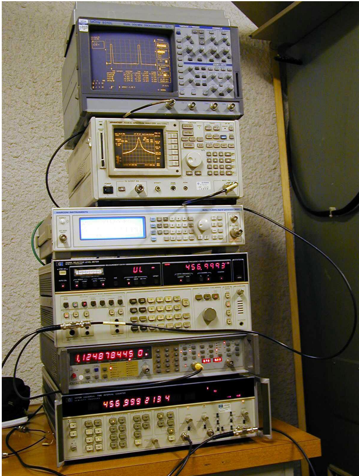
PHOTO 1 : Montage de mesure utilisé pour les chronogrammes à 25°C.
