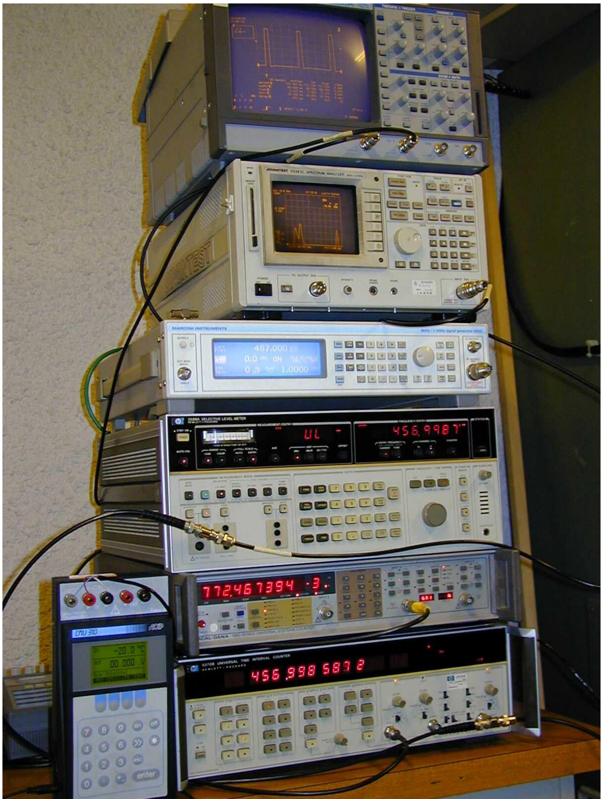
PHOTO 5 : Montage de mesure utilisé pour l'ARVA 9000 A4 à -20^{\circ}\text{C} .
