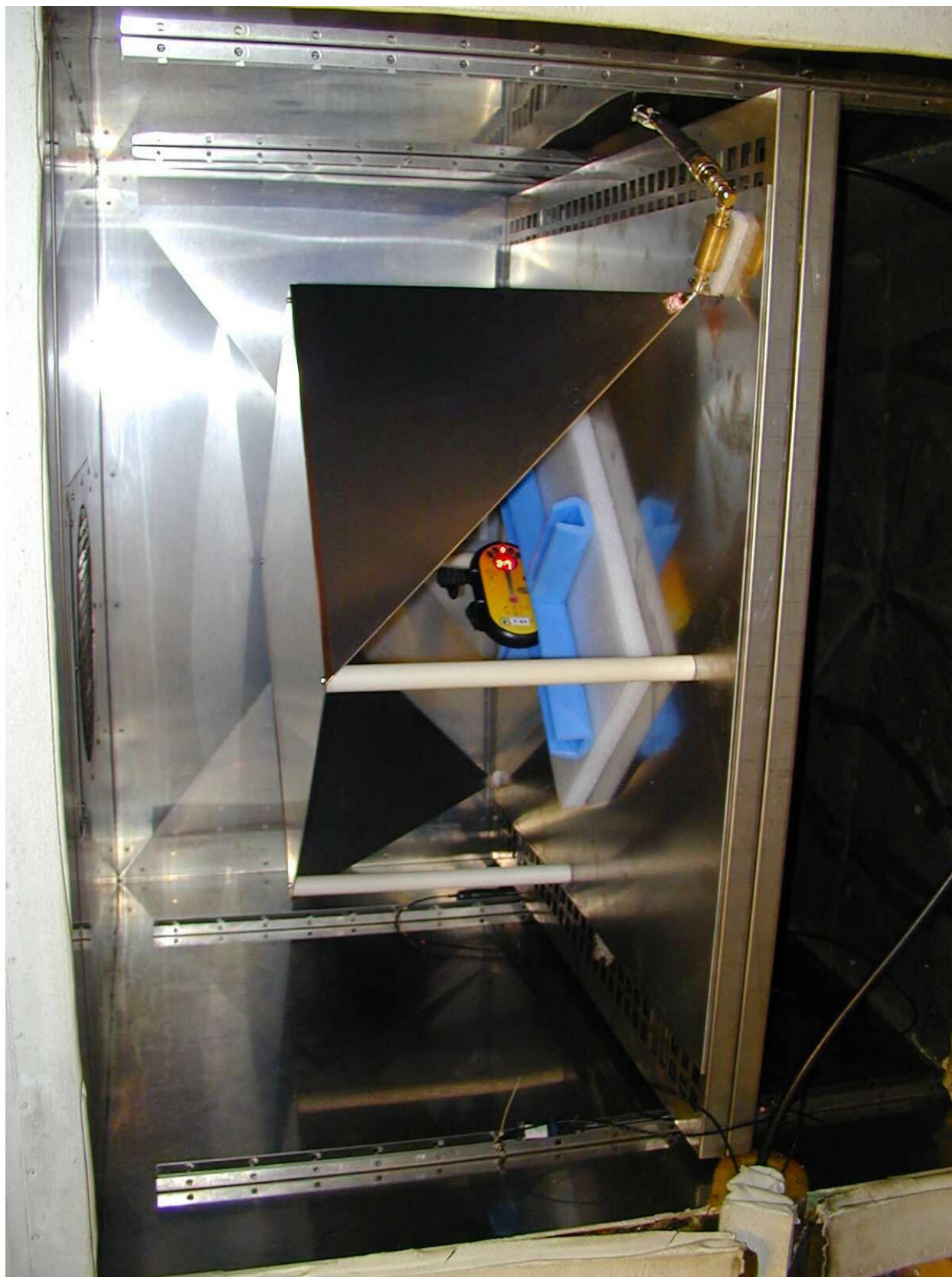
PHOTO 9 : Essais climatiques en cellule TEM.
